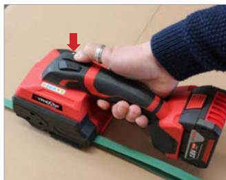
Tensionamento tramite pulsante Tensioning by button
