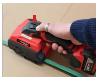
Saldatura e taglio tramite pulsante Push button welding and cutting
