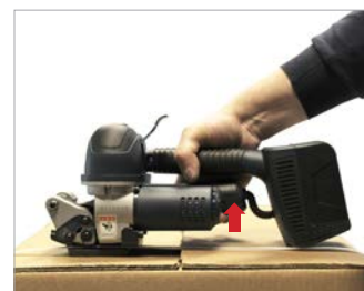
Sgancio della reggetta tramite leva Strap outfeed by handle
