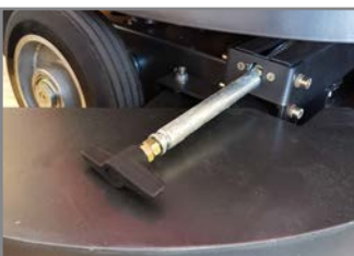
SISTEMA SBLOCCO DEL TIMONE HANDLE RELEASE SYSTEM
