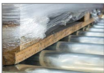
RULLIERA MOTORIZZATA TRASPORTO PALLET POWER RULLIER CONVEYOR
