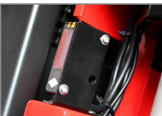
FOTOCELLULA LETTURA VALIGIA PHOTOCELL TO DETECT LUGGAGE HEIGHT
