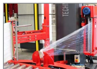
SISTEMA AGGANCIO E TAGLIO DEL FILM FILM CUT AND CLAMP SYSTEM
