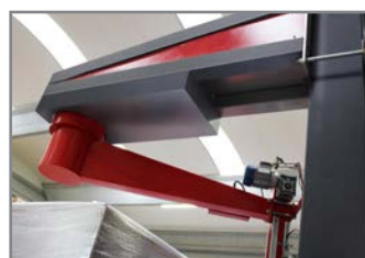
PARTICOLARE RUOTA MOTRICE ROTATING ARM DETAIL
