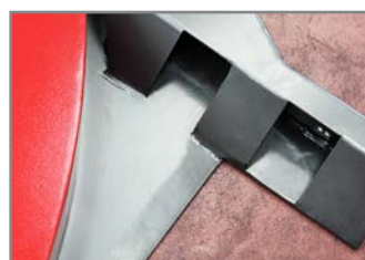
FOTOCCELLULA SICUREZZA ENTRATA TRANSPALLET SAFETY PHOTOCCELL PALLET ENTRY
