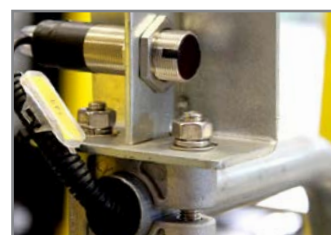
FOTOCELLULE RILEVAMENTO PALLET PALLET DETECTION PHOTOCELLS
