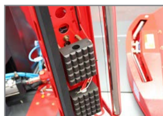
SISTEMA DI AGGANCO E TAGLIO FILM FILM CUT AND CLAMP SYSTEM
