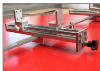
SISTEMA DI BLOCCAGGIO PRODOTTO PRODUCT LOCKING SYSTEM
