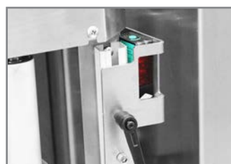
FOTOCPELLA LETTURA PALLET PHOTOCELL TO DETECT PALLET HEIGHT
