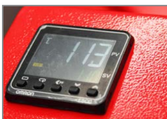
TERMOREGOLATORE SALDATURA FILM SYSTEM CONTROLLED TEMPERATURE
