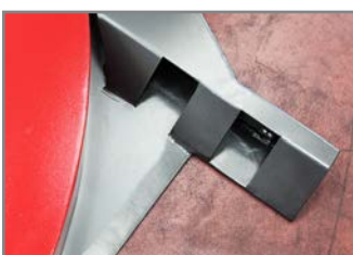
FOTOCPELLULA SICUREZZA ENTRATA TRANSPALLET SAFETY PHOTOCCELL PALLET ENTRY
